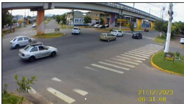
IMAGEM 3: Captura da filmagem realizada na Interseção I para a contagem de veículos.
